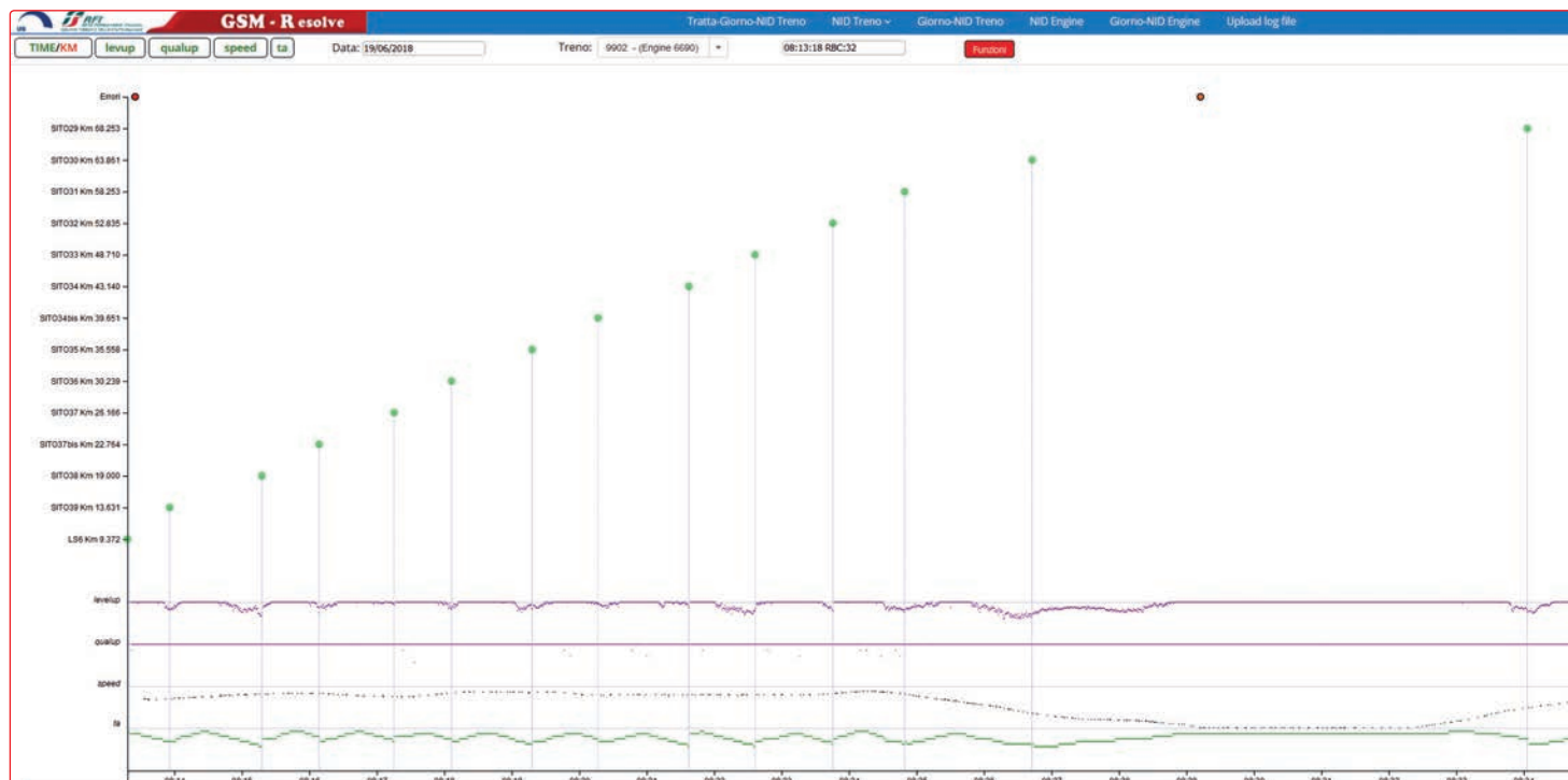
Fig. 14 - L'immagine mostra le BTS attraversate con livello, qualità, velocità del treno, time advance e le anomalie
